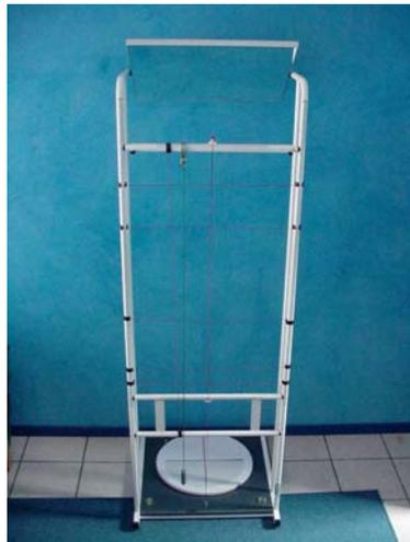
**IL FILO A PIOMBO ANTROPOMETRICO CON MISURATORE DI FRECCIA:** permette di arrivare sul punto più posteriore della cresta sacrale situato nella piega interglutea e di misurare le diverse distanze (frecce) prese su punti di repere standard : rachide cervicale, rachide lombare.
